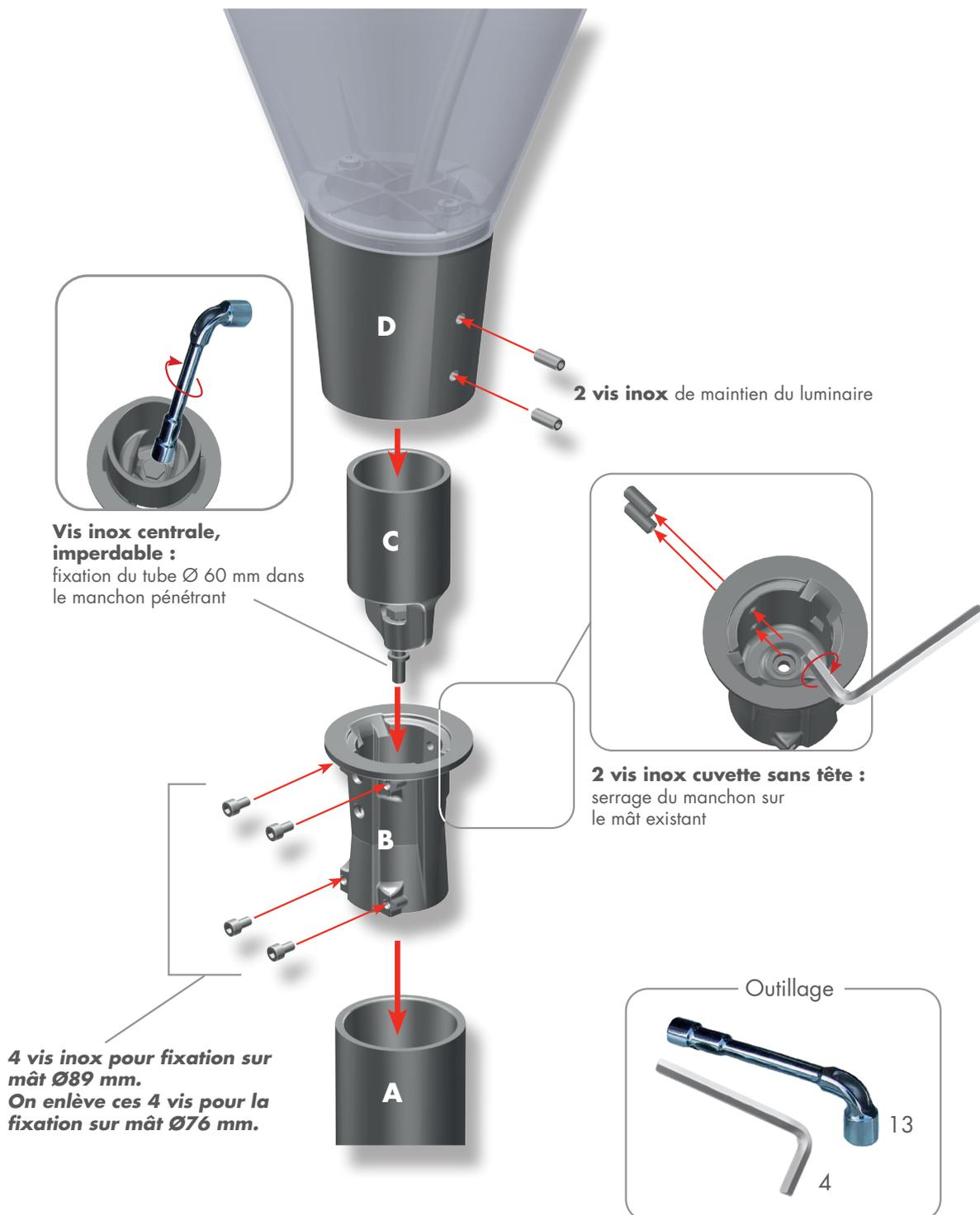
Désolidariser la pièce **C** de la pièce **B**. Insérer la pièce **B** dans le mât **A**, serrer les 2 vis inox cuvette sans tête à l'aide d'une clé Allen de 4 par l'intérieur. Insérer ensuite la partie **C** dans la pièce **B** puis serrer la vis inox centrale, imperdable. Finalement emmancher le luminaire **D** sur la partie **C** et visser les 2 vis inox de maintien du luminaire.
